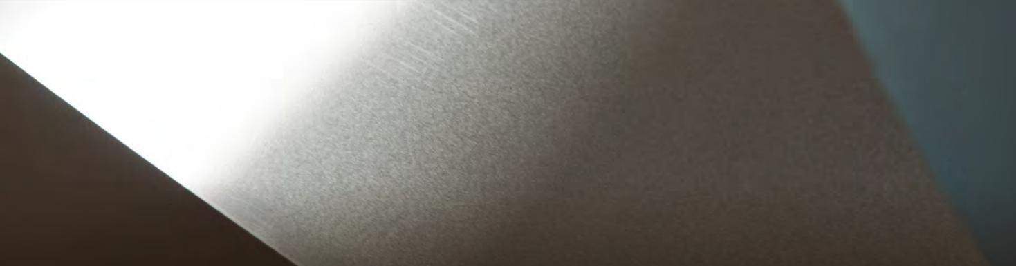
Esta Aleación de Aluminio se caracteriza por una mayor concentración de Manganeso lo que le da mayor resistencia mecánica, buena resistencia a la corrosión y buena conformación en frío, debido a lo anterior es que la aleación de aluminio AA 3003 H14 es la que habitualmente se recomienda en los proyectos de aislación térmica
