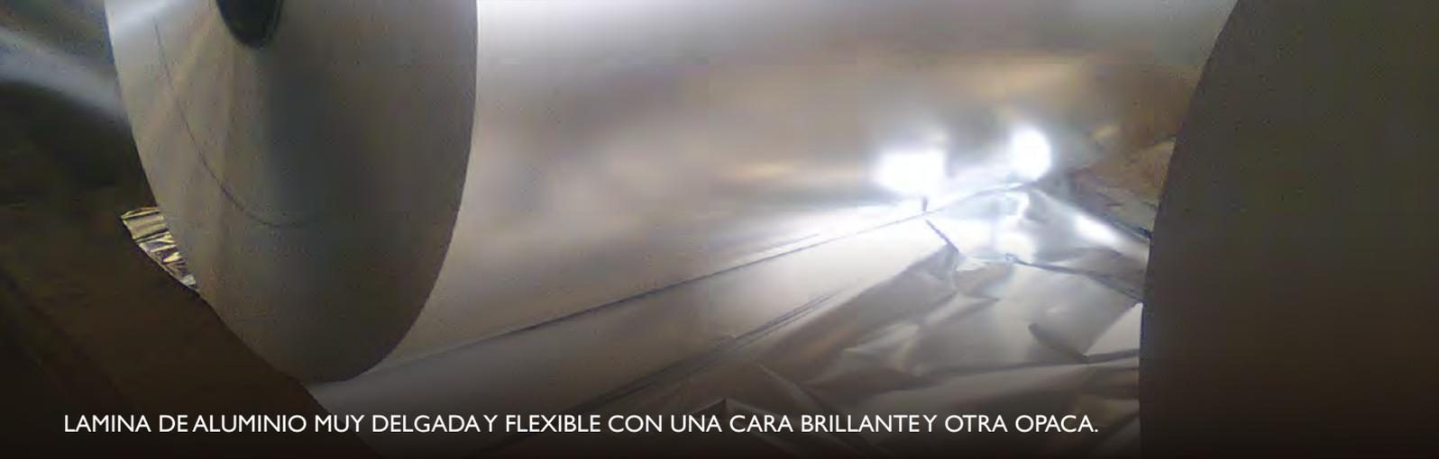
LAMINA DE ALUMINIO MUY DELGADA Y FLEXIBLE CON UNA CARA BRILLANTE Y OTRA OPACA.
