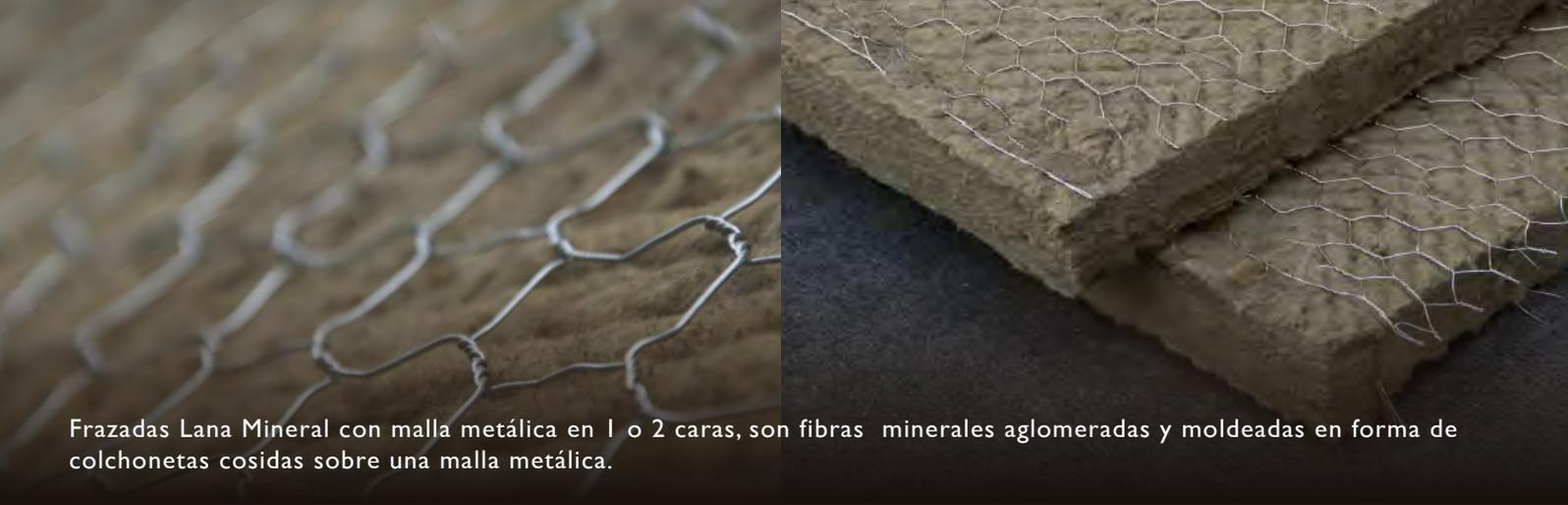
Frazadas Lana Mineral con malla metálica en 1 o 2 caras, son fibras minerales aglomeradas y moldeadas en forma de colchonetas cosidas sobre una malla metálica.
