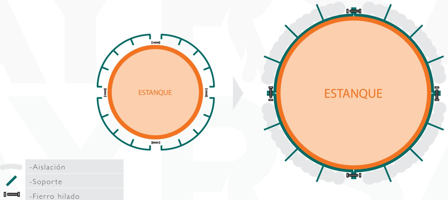
Para la parte inferior y superior del estanque, se deberá confeccionar soportación desde el anillo superior e inferior del manto en el caso que corresponda y esta dependerá de la forma del equipo en cada caso.
