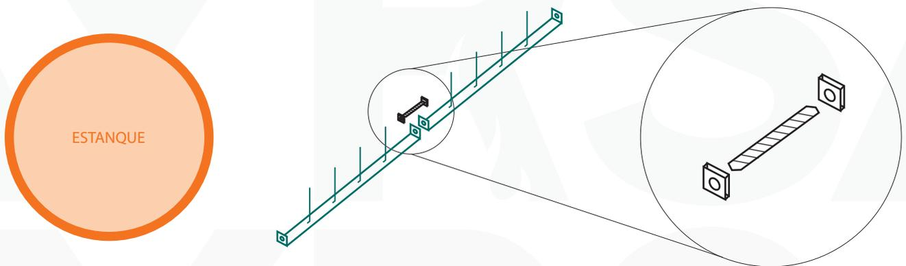
La cantidad de anillos de soportación de aislación deberá ser determinada por el montajista en base a la altura del estanque y las dimensiones del material de aislación.
